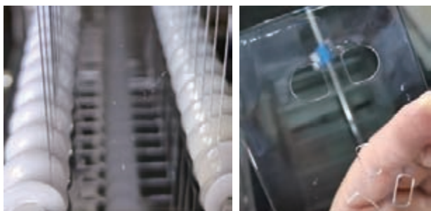
图 1 光学玻璃清洗后有残留物 图 2 光学玻璃清洗后的发蓝现象
